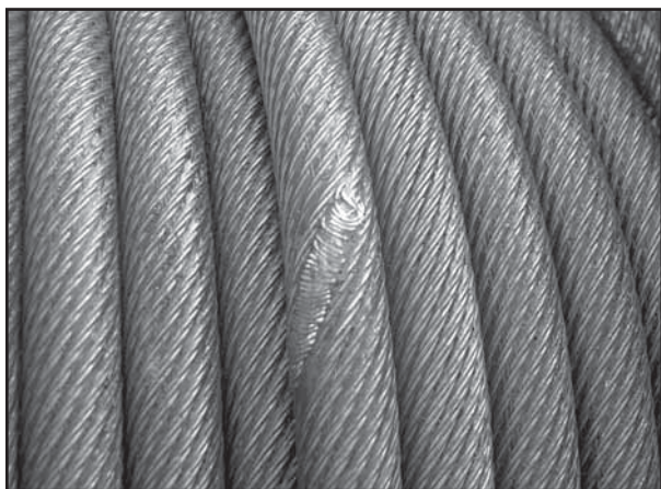
Figur 144: Denne kordelomvikling ble ikke oppdaget under produksjon og dukket opp som en ubehagelig dekorasjon på det ferdige ståltauet.
