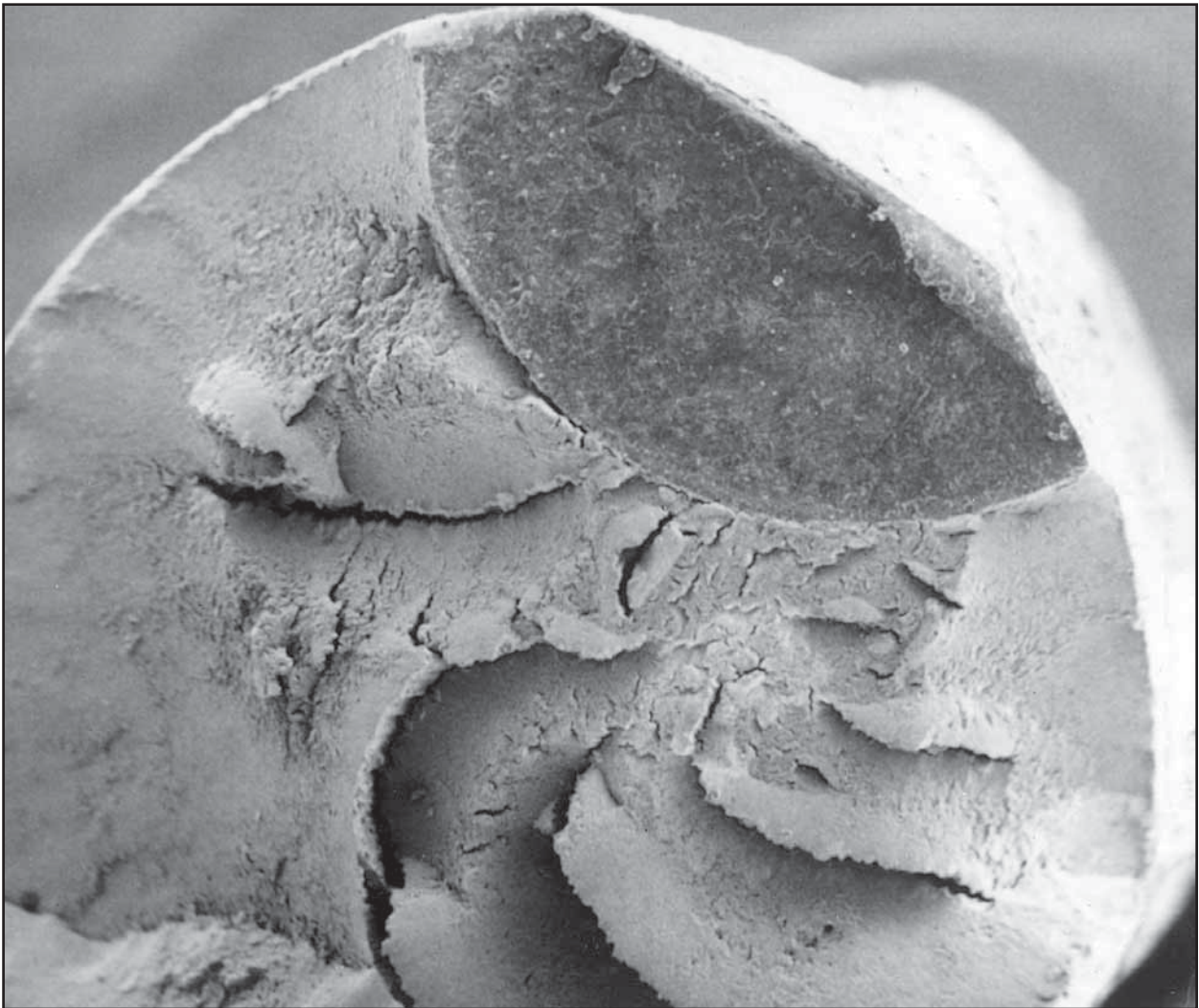
Figur 15: Utmattingsbrudd starter på kontaktpunktet mellom tråden og skiva. Vi ser at bruddet utvikler seg konsentrisk fra kontaktpunktet. (Felles midtpunkt i sentrum i halvsirkelen). Bruddet ble synlig etter en strekkprøve av tråden.
