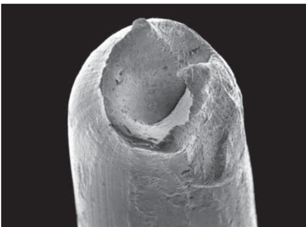
Figur 39: Denne lokalt skadde tråden fikk strekkbrudd.
