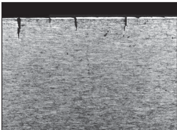
Figur 66: Martensittlag på overflaten av en ståltråd.
