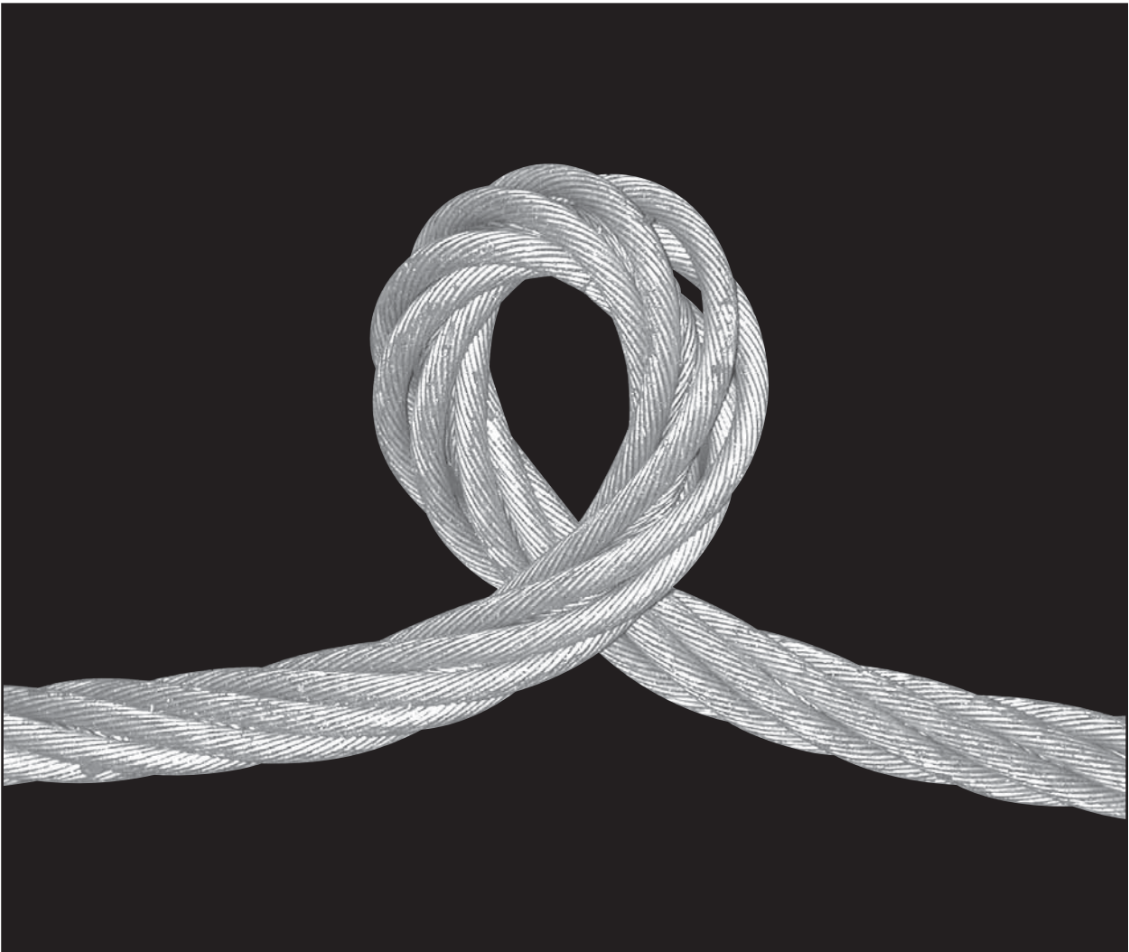
Figur 104: Dette ståltauet er vridd mot slagretningen. Når det er slakt vil det forme en løkke med slagretningen. Når løkker får last, kan de trekke seg sammen og permanent deformere ståltauet.
