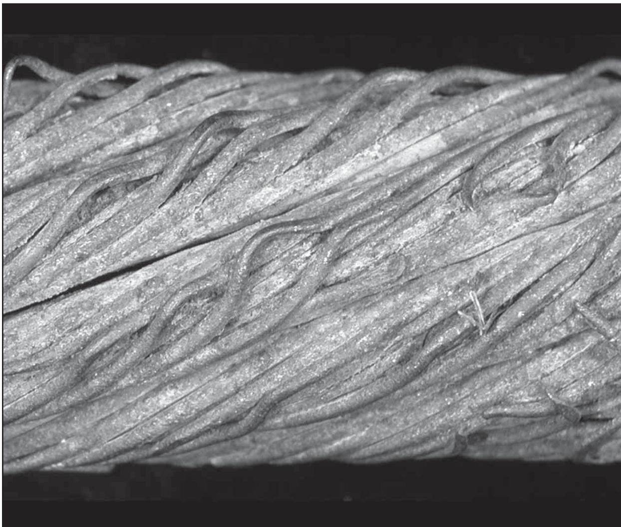
Figur 80: Dette løftetauet fra en støpekran har vært utsatt for høye temperaturer i for lang tid. Som et resultat av dette har yttertrådene glødet, myknet og blitt lengre.
