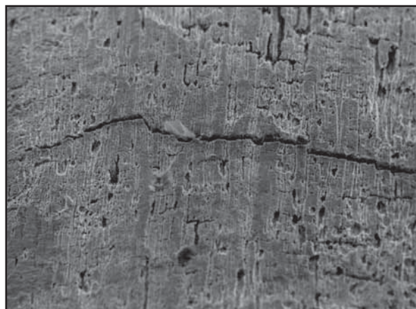
Figur 14: Korrosjon og punkt-tæring (pitting). Forstørrelse av figur 13.
