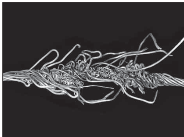
Figur 101: Noen ganger innvirker vridningen kun på den innerste part som er kortest og den eneste rette part i ståltauet.
