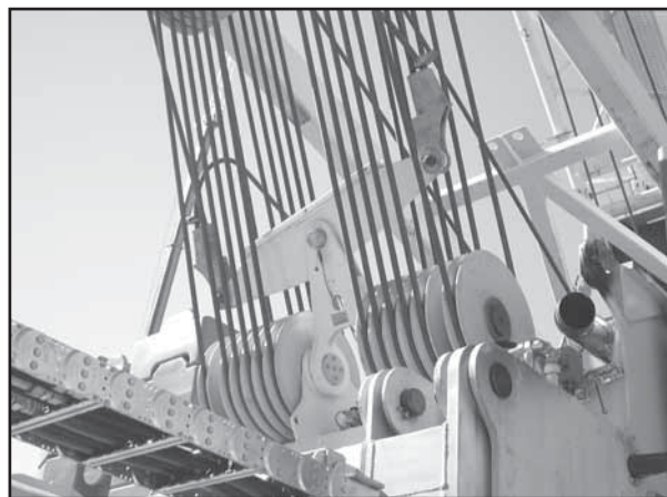
Figur 147: I en flerlags spoling, liten diameterforskjell på to ståltau vil lede til stor forskjell i de oppspolede ståltauene.
