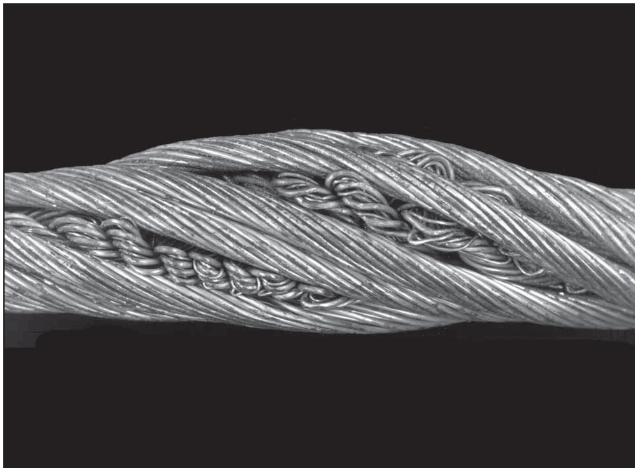
Figur 97: Overskudd av kordel-lengder fra stålkjernen forårsaket av vridning som har blitt presset sammen til et punkt ved en skive. Feil som disse finner du vanligvis på slutten av bevegelsen mot skiva (eller ved ståltauet over skiva).
