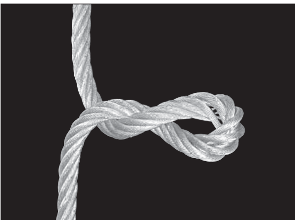
Figur 105: Dette ståltauet har blitt vridd med slagretningen. Når det blir slakt vil det danne en løkke mot slagretningen.
