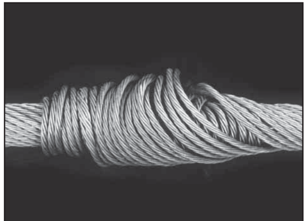
Figur 110: Et annet eksempel på fuglebur på et rotasjonsfattig ståltau.
