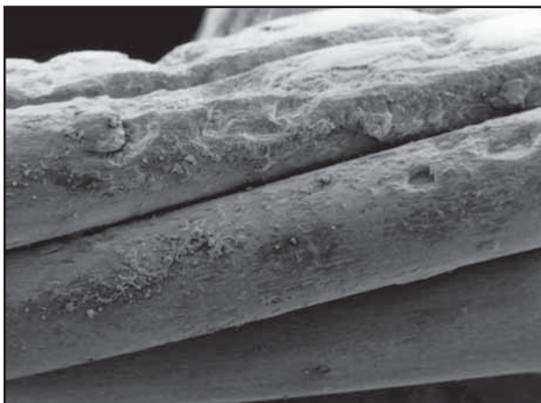
Figur 29: Gravrust (lokalt rustangrep som lager dype hull).
