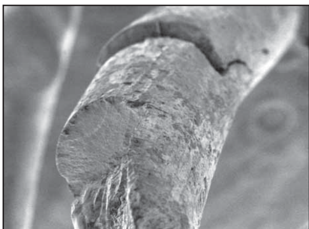
Figur 22: To nærliggende tretthetssprekker. Denne type brudd opptrer ofte i ståltau hvis trådene får uavhengig bøyning og sammenstrykking.
