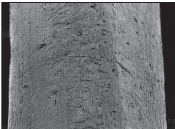
Figur 13: Overflate korrosjon starter ofte utmattingsbruddenes mønster.
