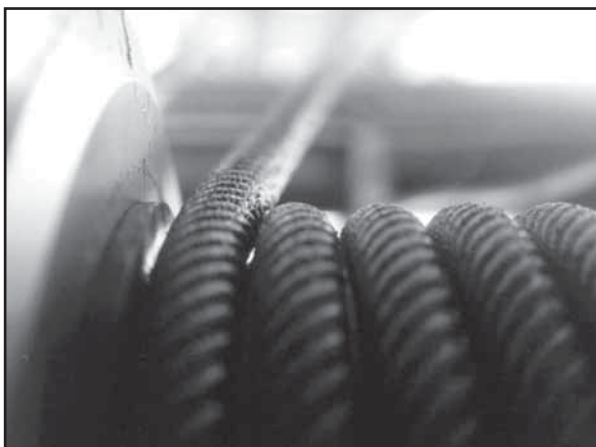
Figur 128: Innfallsvinkelen tvinger ståltauet til å presse på nabovindingen som forårsaker slitasje og vridning av ståltauet.
