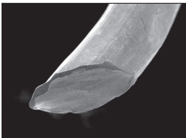
Figur 49: Et annet skjærbrudd. Hvis du har sett et....
