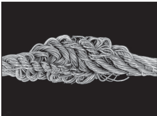
Figur 98: Her er de ytre kordelene fra figur 97 fjernet. Det viser overskuddet av kordellengder som er presset sammen i kjernen.
