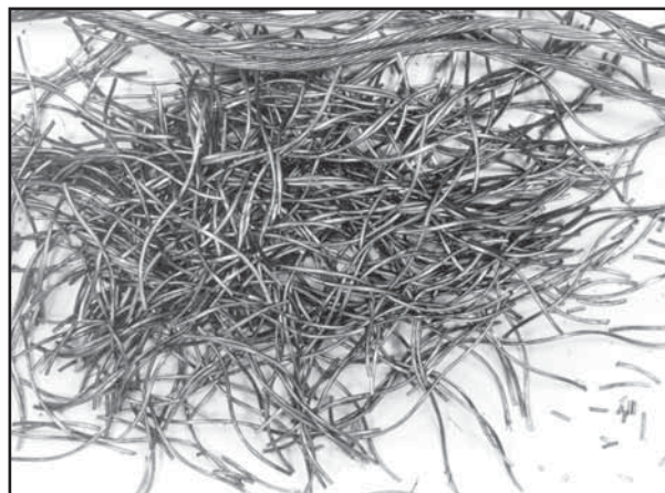
Figur 85: Åpningen av dette kasserte ståltauet beviste at stålkjernen ikke lenger var i god form.
