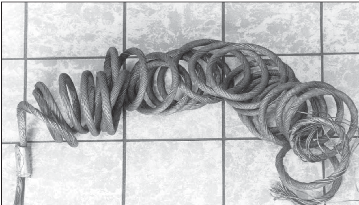
Figur 62: Ståltau som har blitt dratt over en skarp kant har en tendens til å kveile seg når tauet er uten last.
