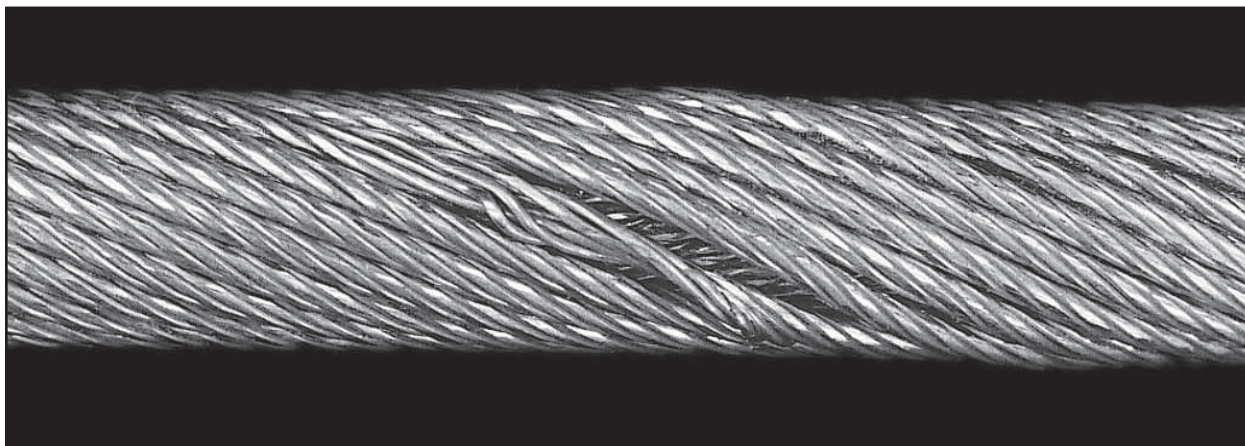
Figur 143: Produksjonsfeil når dette ståltauet ble slått. Denne slagingsfeil ble ikke oppdaget før den ble innesluttet av ytre parter.
