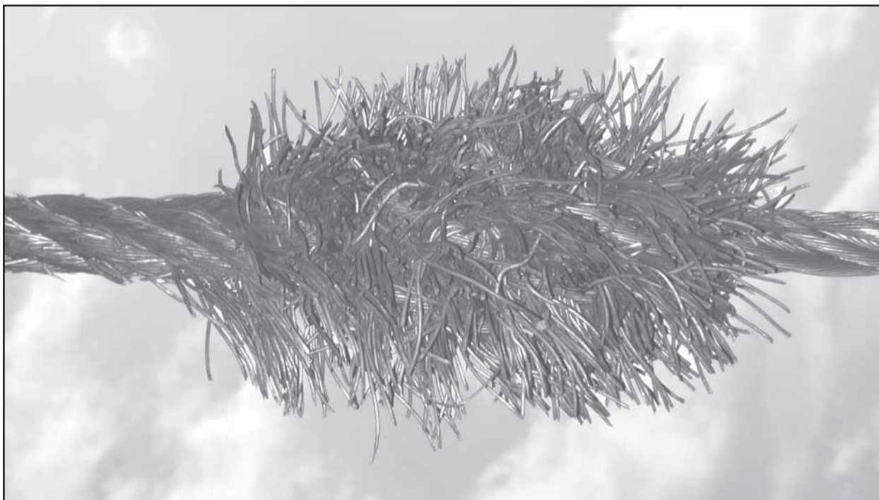
Figur 61: Lukke tau til en grabbkran. Alle yttertrådene har brudd på grunn av stor avsliping. Det traktformede hullet for ståltauet på grabben har skjøvet alle løse tråder langs ståltauets lengde til en plass. Dette laget dette imponerende pinnsvinet.
